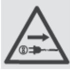
Antes de configurar la máquina o su mantenimiento, o si la línea de alimentación eléctrica se ha quedado atrapada o dañada, ¡apague siempre el motor y desenchufe la clavija de la red eléctrica!
