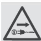
Перед выполнением регулировки устройства или его обслуживания или, если электрический силовой кабель зацепился или поврежден, всегда выключите электромотор и выньте вилку из розетки электрической сети питания!
