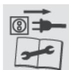
Avant de réaliser des travaux sur les matériels de scarification/aération, sortez la fiche du câble électrique de la prise d'alimentation électrique.
