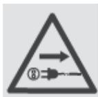
Prieš reguliuojant mašiną arba to priežiūrą, arba jeigu elektros linija yra sulaukyta arba pažeista, visada išjunkite variklį ir ištraukite kištuką iš elektros tinklo lizdo!
