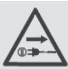
Před provedením nastavení stroje nebo jeho údržby, nebo pokud se elektrické přírodní vedení zachytilo nebo je poškozené, vypněte vždy motor a vytáhněte vidlici ze zásuvky elektrické sítě!
